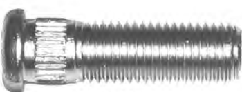
561-110 M12 x 1.5 x 43mm Knurl diameter: 13mm (Code M.1.7)
